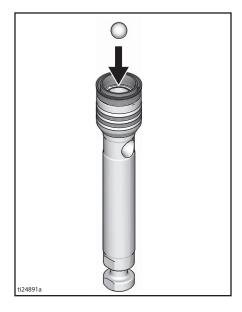
3. Torque to  $27 \pm 3$  ft-lb  $(37 \pm 4 \text{ N} \cdot \text{m})$ .
